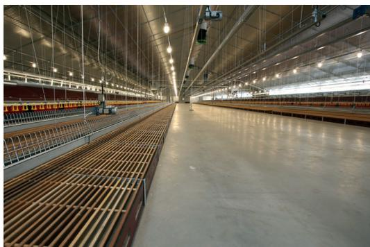
Гнездо Van Gent сделано из дерева и способствует естественному поведению птицы. Конструкция прочная и простая, что делает гнездо легким в сборке и чистке. Гнездо оснащено автоматической системой выгона. Система выгоняет птицу из гнезда после откладки яйца, предотвращая появление напольного и загрязненного яйца. Гнездо Van Gent выпускается в 1 или 2 яруса, одноярусное (пристенное) или двухъярусное (стандарт XL).
